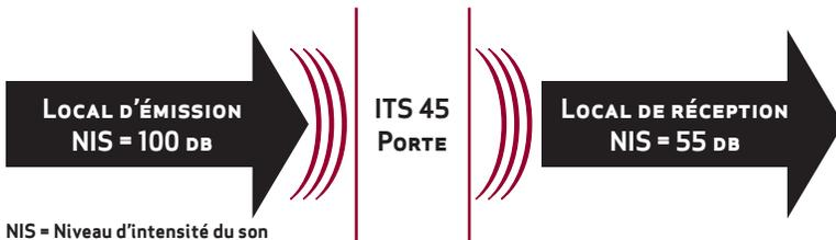
L'ITS est déterminée par la moyenne pondérée de la valeur de perte de transmission relevée à 16 fréquences (ASTM E413).
